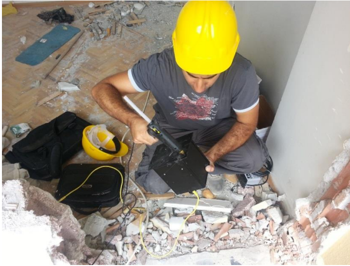
Şekil-7- Sensörlerin silikonla yapıştırılması
